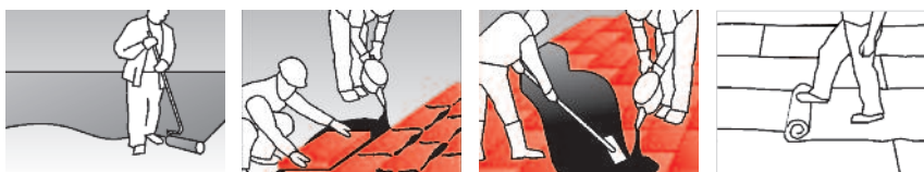
Collage à chaud des plaques FOAMGLAS® (bain de bitume)
